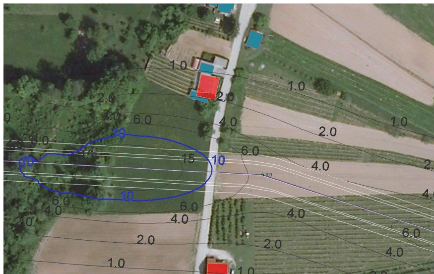
Slika 10: Prikaz podrobnega mikrolokacijskega izračuna magnetnega polja B [ \mu\text{T} ] 1 m nad tlemi pri izbranem objektu.
