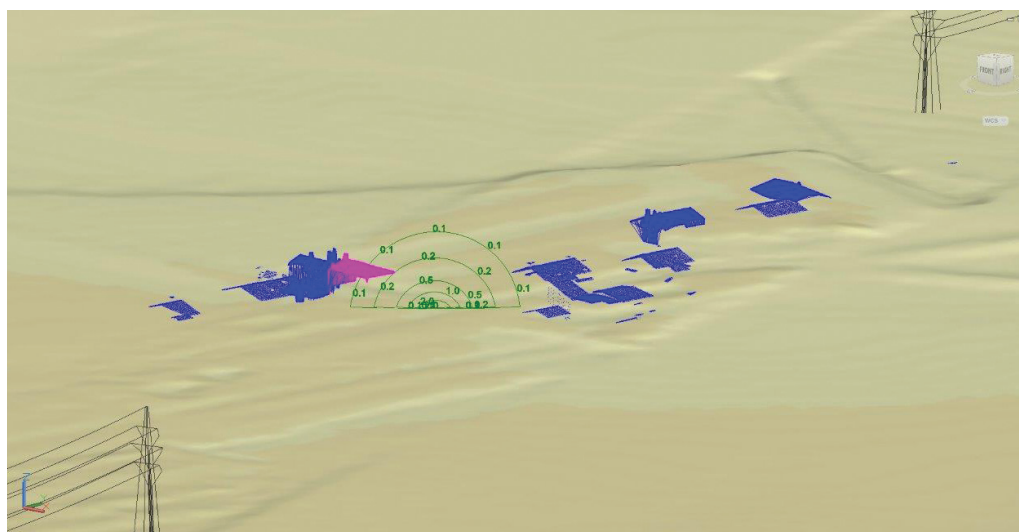
Slika 15: Prikaz podrobnega mikrolokacijskega izračuna magnetnega polja B [ \mu\text{T} ] v pravokotni prerezni ravnini na os podzemnega voda pri izbranem objektu.
