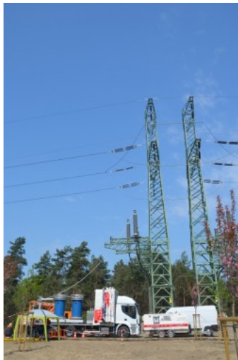
Merilna oprema (sistem za preizkušanje VN opreme z metodo ACRF na tovornjaku EIMV) v Varšavi na mestu preizkusov; Foto: Simon Podkoritnik
